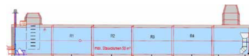
Stauraumkanal mit integrierter Drossel in nasser Aufstellung
