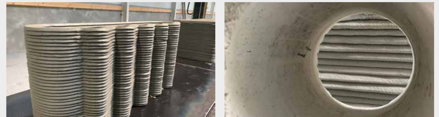
Kernbohrung durch ein 3D gedrucktes Bauteil.
